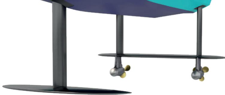
Grâce à un contact minimal avec l'eau, le foil génère peu de trainée et offre à la SeaBubble une réduction de consommation de son énergie embarquée.
